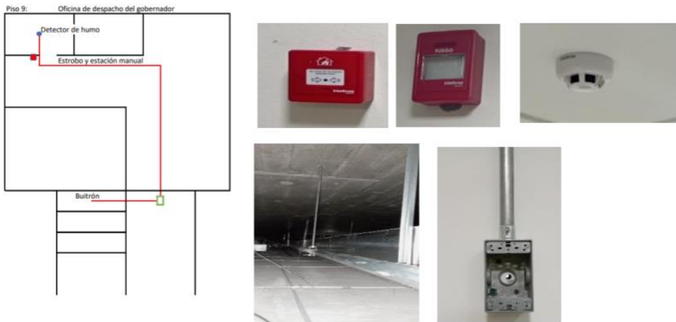
Figura 54- Plano instalación sensor de humo
